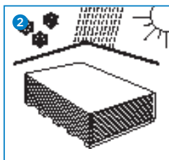
Rigips Platten vor Feuchtigkeit und Witterung schützen
