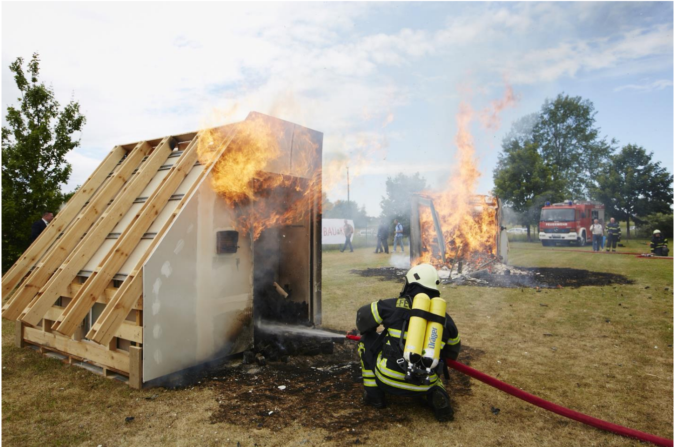
Bild 1: Brandausbreitung bei Konstruktionen mit und ohne baulichem Brandschutz
