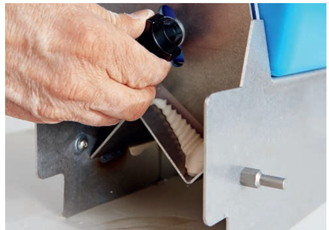
Zum leichteren Einführen des Rigips Levelline in den Zufuhrbehälter lässt sich die Öffnungsgröße mittels einer Stellschraube regulieren.
