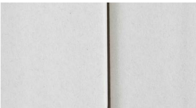
Obere Platte: gefaste Kante an Untere Platte: scharfe Schnittkante
