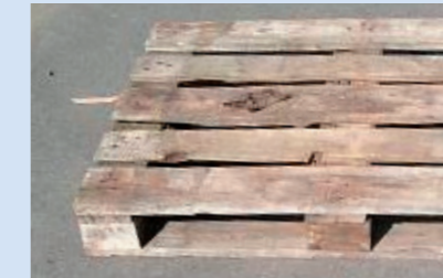
Es sind auf jeder Seite nicht mindestens ein Zeichen einer Bahn, ein Zeichen „EUR“, „UIC“ oder „EPAL“ auf einem Eck-Klotz vorhanden
