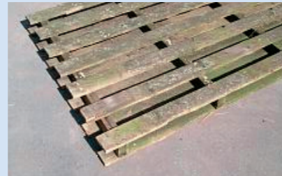
Nicht ausreichende Tragfähigkeit (morsches, faules, sprödes Holz, fehlende Nagelfestigkeit)
