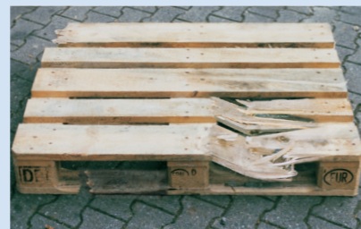
Mehr als 3 Bauteile defekt
