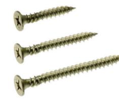
**Produktbeschreibung:** Typ TUN nach DIN EN 14566. Aus Stahl, spezialbehandelt, C3 beschichtet, mit Schneidringkopf, Kreuzschlitz PH Gr.2 und gegenläufigem Gewinde unterhalb des Schraubenkopfes.
